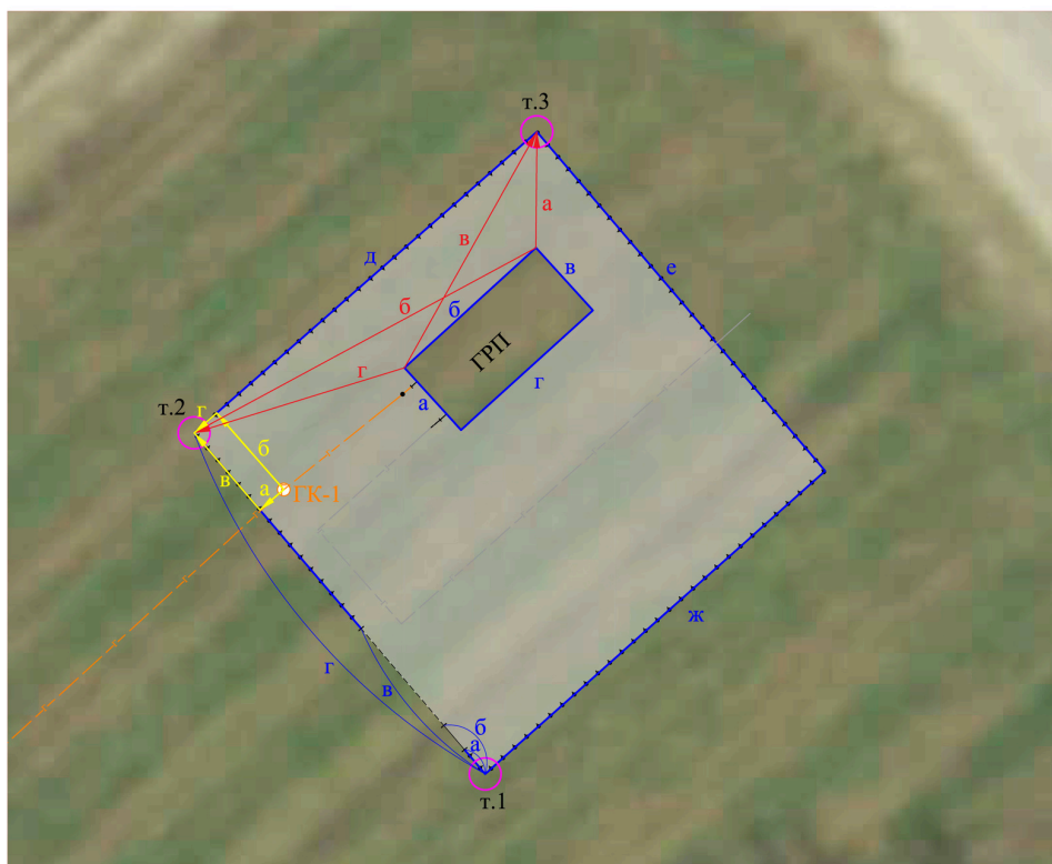
Рис. 12. Горизонтальная съемка методом обмеров, створов и перпендикуляров
