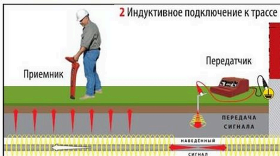
Рис. 14. Индукционный режим поиска трубопровода
